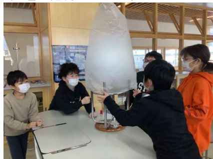
【4年】空気のあたたまり方 温めた空気をビニール袋にためていくと「わあ〜」と歓声上がるほどに袋が舞い上がる実験です。
