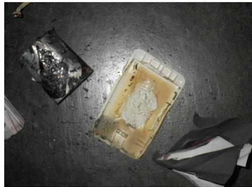
写真6 モバイルバッテリーの焼損状況
