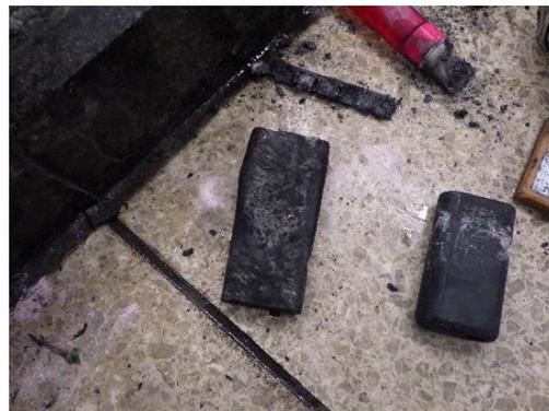
写真2 モバイルバッテリーの焼損状況
