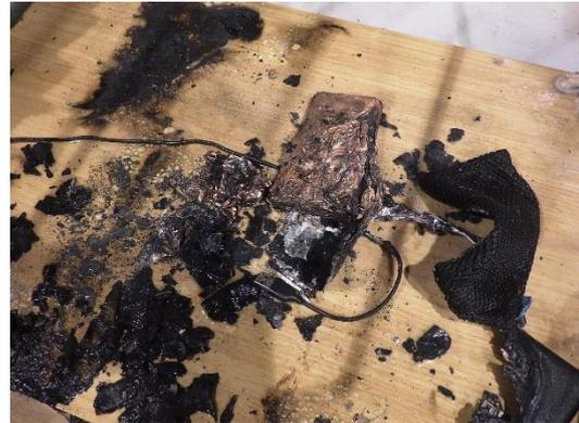
写真10 モバイルバッテリーの焼損状況
