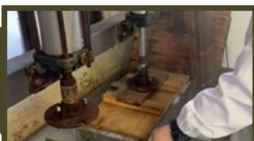
⑦上から押して水をきり、固める
