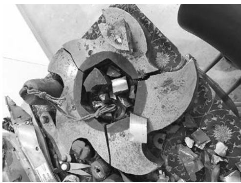
破損した破袋機の刃
