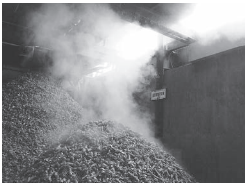
製造された固形燃料 (RDF)
