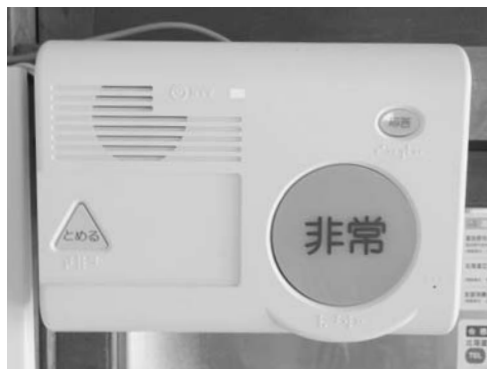
緊急通報システム装置
