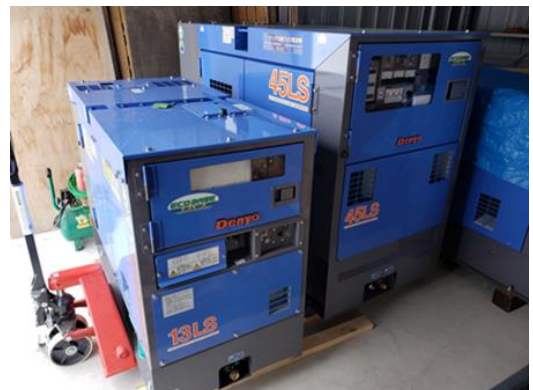
可搬式発電機
