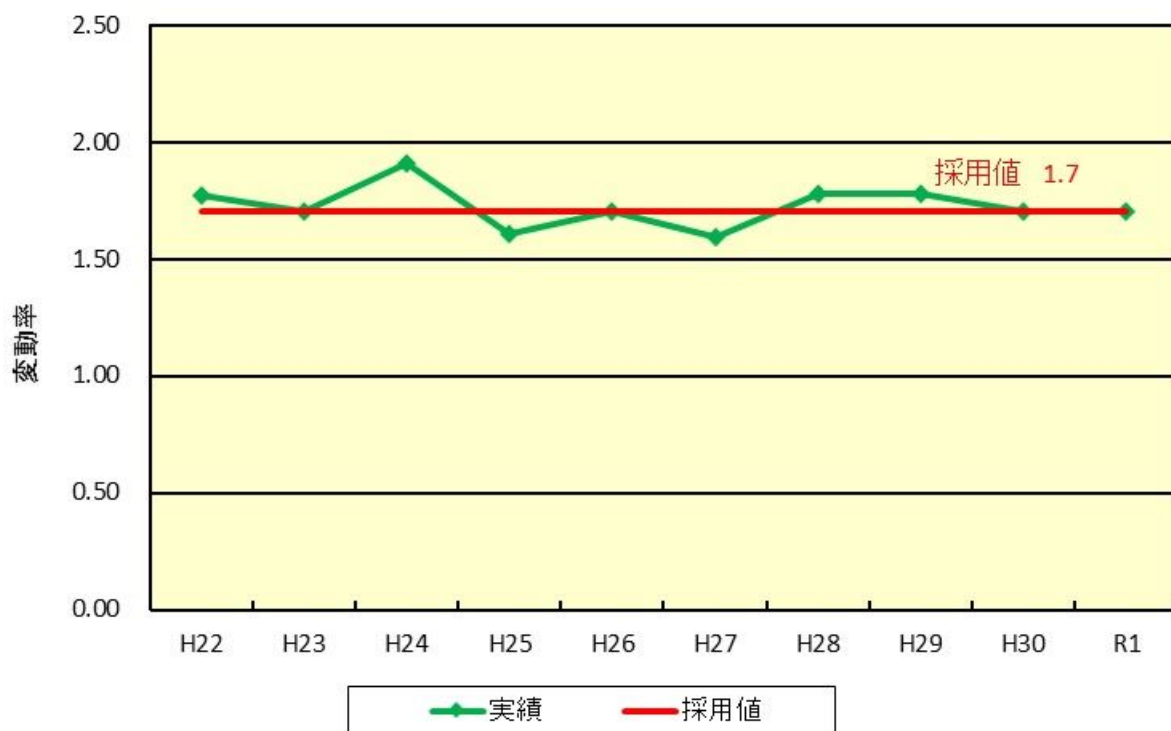
図 4.12 山部水処理センター時間最大変動率推移
