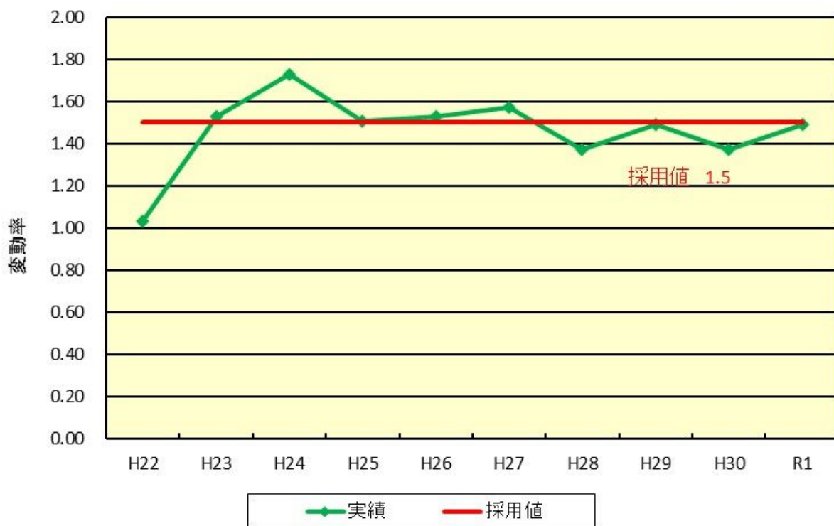
図 4.10 富良野水処理センター時間最大変動率推移
