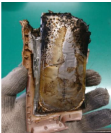
▲固形燃料ごみの処分中に発火し、周囲の可燃物を燃やす原因となったスマートフォン
