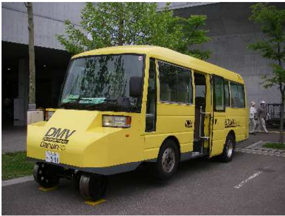
(DMV車：道路とレールを自在に走行可能な車)
